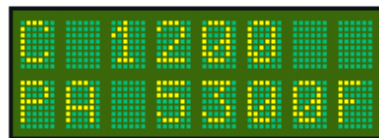
Encoder altitude for "pressure altitude" (1013mB or 29.92HG)
